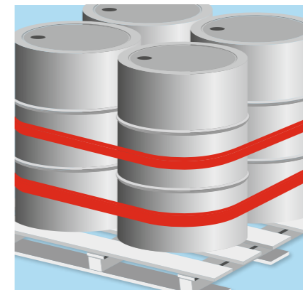
Sicherung von Gefahrgut
